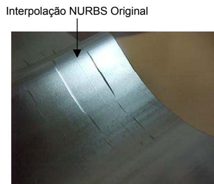
Figura 5.25: Variação da Interpolação NURBS Original no corpo de prova 1.
