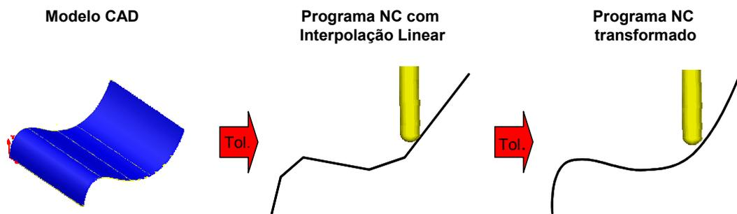
Figura 2.54: Processo de geração de uma interpolação indireta.
