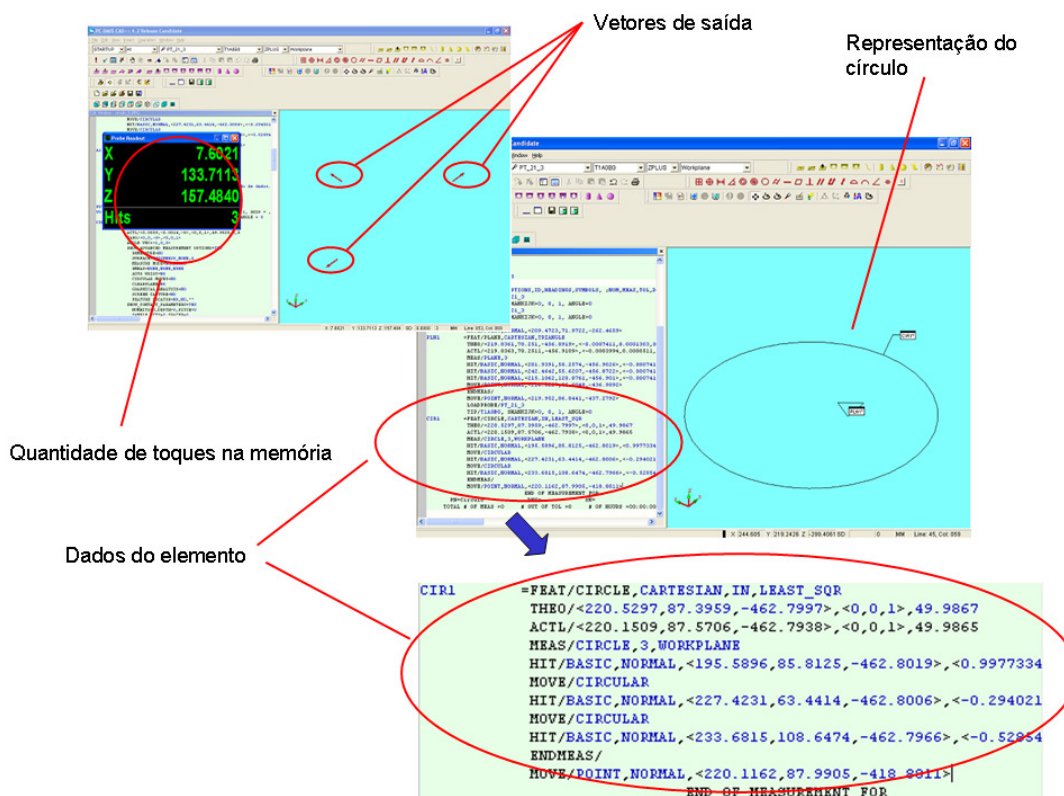
Figura 2.28: Exemplo de utilização de ferramenta de auxílio (PC-DIMS).
