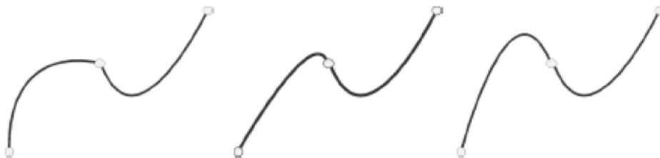
Figura 2.21: Exemplos de continuidade de curvas: continuidade G^0 , G^1 e C^1 .
