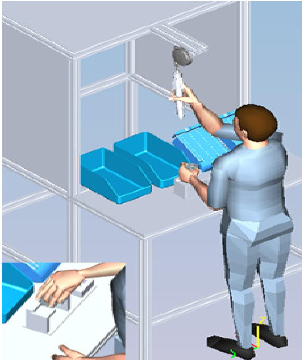
*Figura 5.4: Process Simulate – visão humanoide na simulação de operações.*
