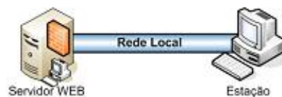
(F) - Estação (máquina real) e Servidor web com firewall (máquina virtual), na mesma rede de comunicação.
