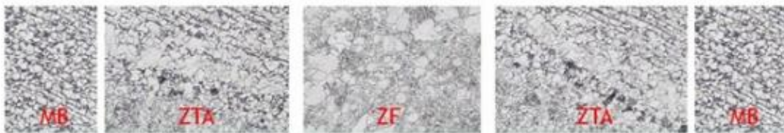
Comportamento de uma aço soldado após tratamento térmico de normalização
